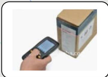
Il picking della merce avviene mediante certificazione del codice prodotto e cella di prelievo, effettuata mediante terminali in radiofrequenza.
